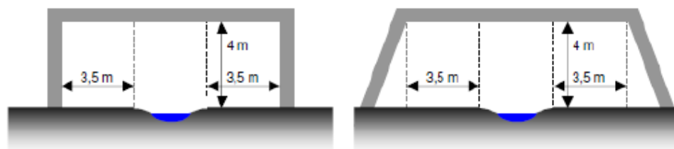
Figur 9.5 Eksempel på faunapassage af typen A2, der er egnet for hjortevildtet (då-hjort og rådyr). På figuren er angivet mindstemålene for at opfylde A2-kravet. Figuren er gengivet fra Vejledning Fauna- og Menneskepassager (Vejdirektoratet, 2011).
